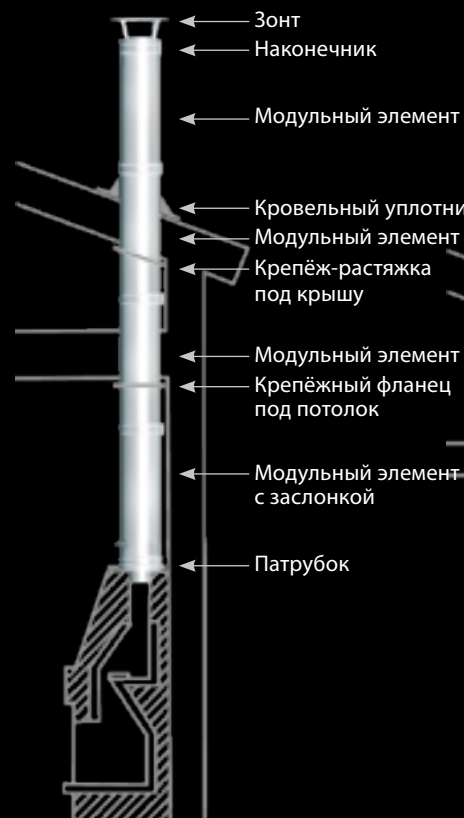
ПОДСОЕДИНЕНИЕ ДЫМОХОДА СВЕРХУ
